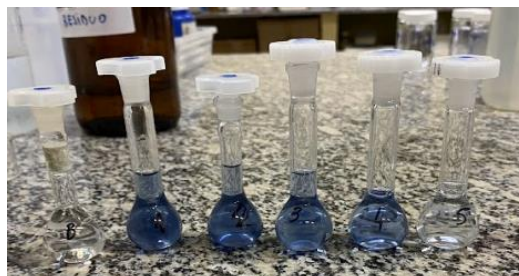
FIGURA 6: Balões volumétricos com o branco e as soluções-padrão para construção da curva analítica.
