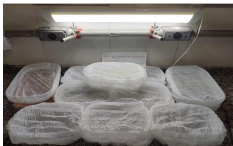
Figura 2: Estrutura de condicionamento dos tanques com banho de luz artificial de lâmpada LED no período noturno por 12 h por dia.
